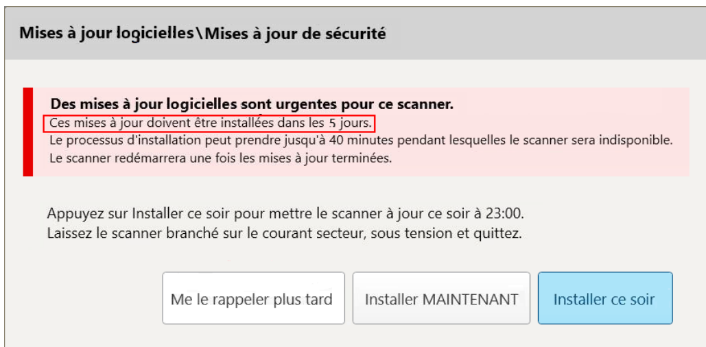
Figure 44: Mises à jour de sécurité – nombre de jours avant l'installation obligatoire des mises à jour
